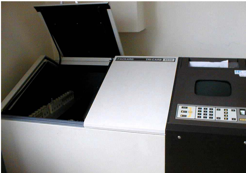
14. fénykép. TRICARB készülék a kisenergiájú béta-sugárzás mérésére
