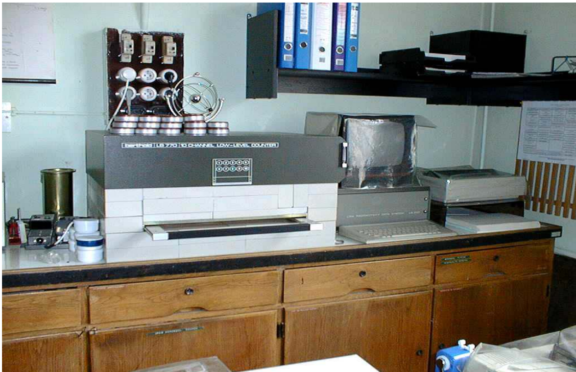
13. fénykép. A 10 mérőhelyes gázáramlásos proporcionális számláló az összbéta aktivitás mérésére
