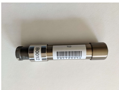
11. ábra. A Pille rendszer dózismérője
