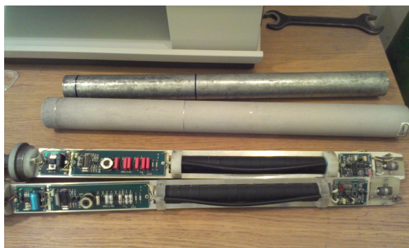
9. ábra. Gamma-szondák és belső szerelvényeik
