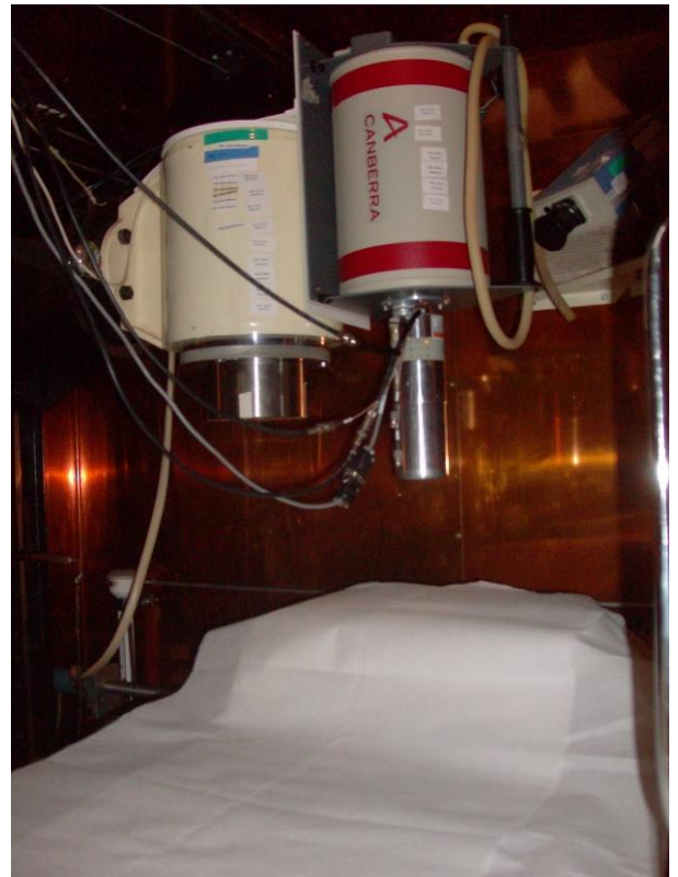
37. ábra: Egésztest-számláló mérőhely belülről
