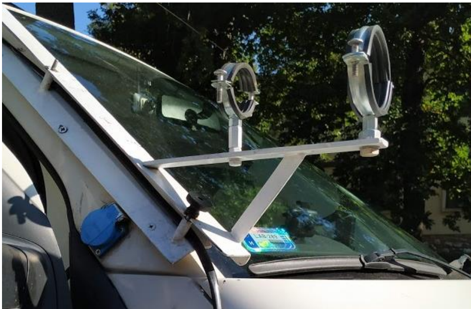
29. ábra Mérőfej felhelyezési lehetőség a szélvédő oldalánál
