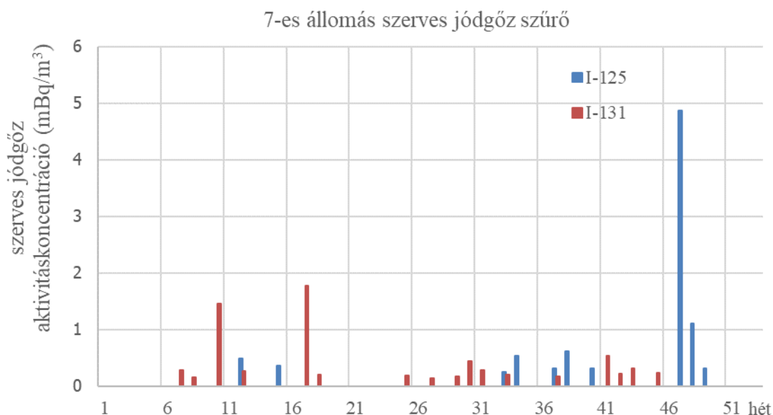
23. ábra: A levegő ^{125}\text{I} és ^{131}\text{I} (szerves jódgőz) tartalmának heti átlagos aktivitáskoncentrációja 2023-ban a 7. állomáson (kimutatási határ ^{125}\text{I} : 0,25 mBq/m 3 , ^{131}\text{I} : 0,15 mBq/m 3 )
