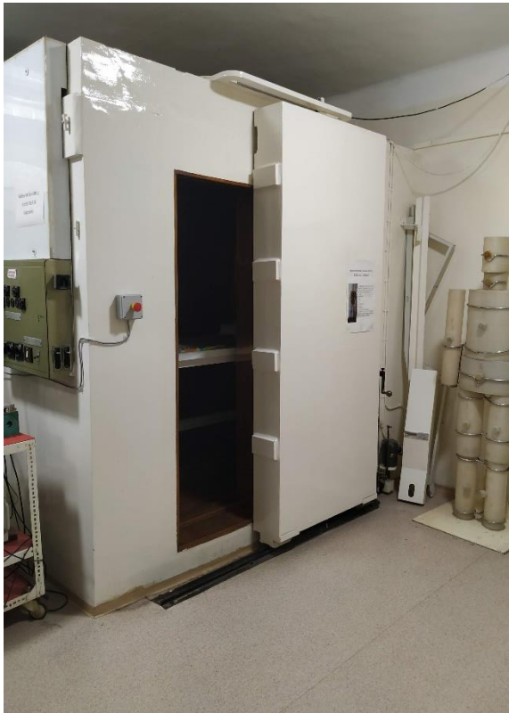
36. ábra: Egésztest-számláló mérőhely kívülről
