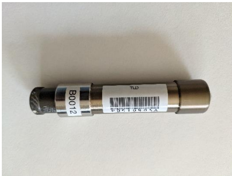
11. ábra: A Pille rendszer dózismérője
