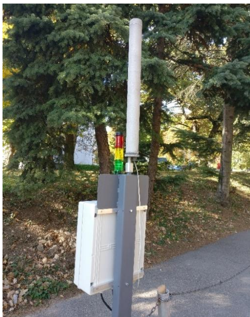
7. ábra: A gamma-szonda mérőpontok jelzése a Telephely fényképén
