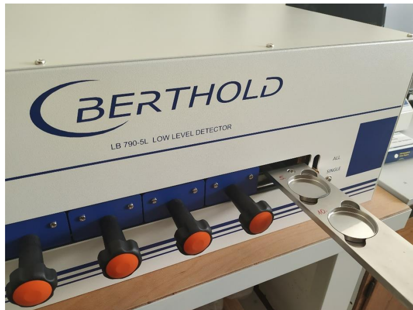
13. ábra: LB 790 Berthold béta-aktivitásmérő
