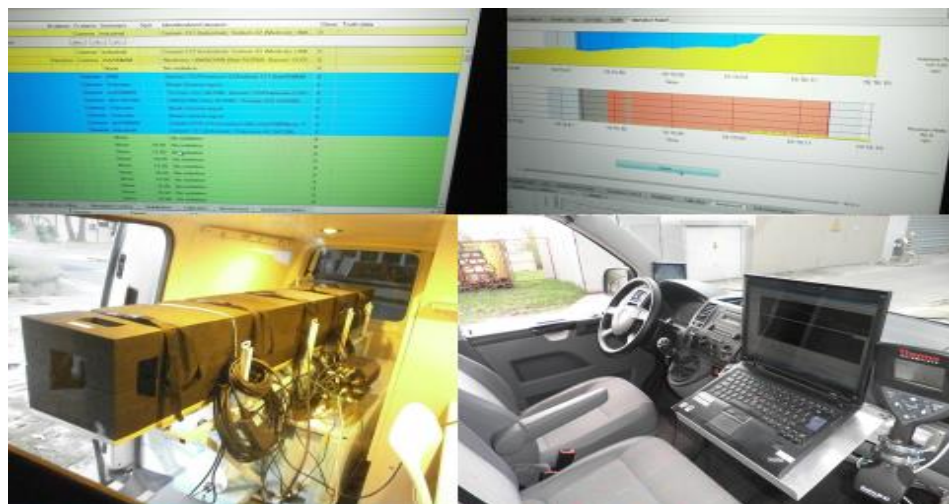
31. ábra: A mozgólaboratóriumba szerelt nagyérzékenységű detektorrendszer elemei
