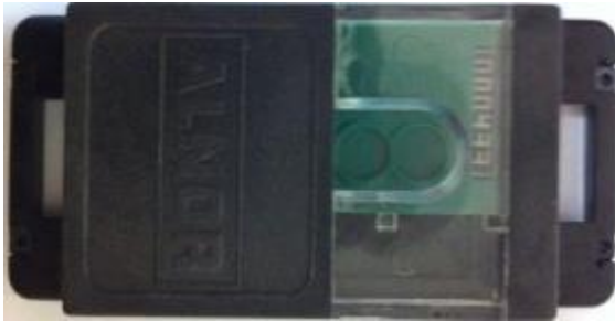
32. ábra: Albedo neutrondosiméter
