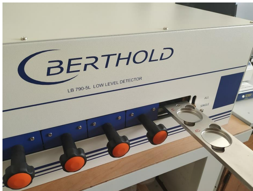
13. ábra: LB 790 Berthold béta aktivitásmérő
