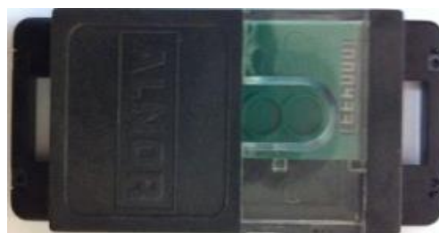
34. ábra: Albedo neutrondoziméter
