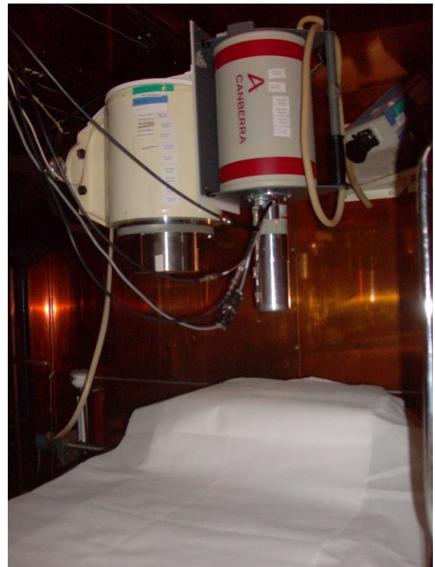
37. ábra: Egészszteszámológó mérőhely belülről
