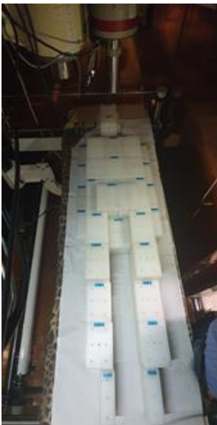
41. a és b ábra: A radioaktív forrást tartalmazó blokkok emberi testformát utánozó elhelyezése
