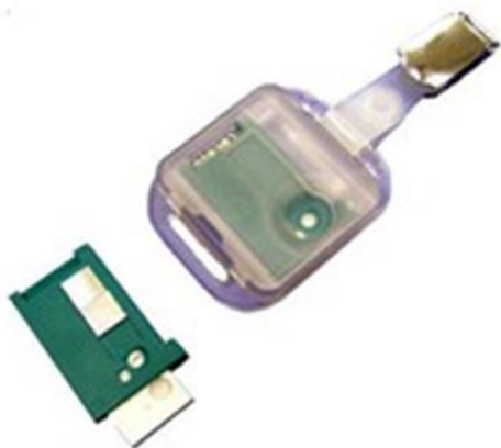
33. ábra: RADOS gamma–doziméter tok és kártya
