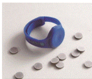
35. ábra: Gyűrűdoziméter és LiF kristályok
