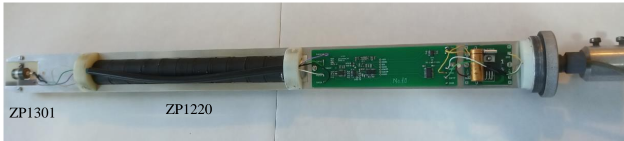
9. ábra: Gamma-szonda és belső szerelvényei
