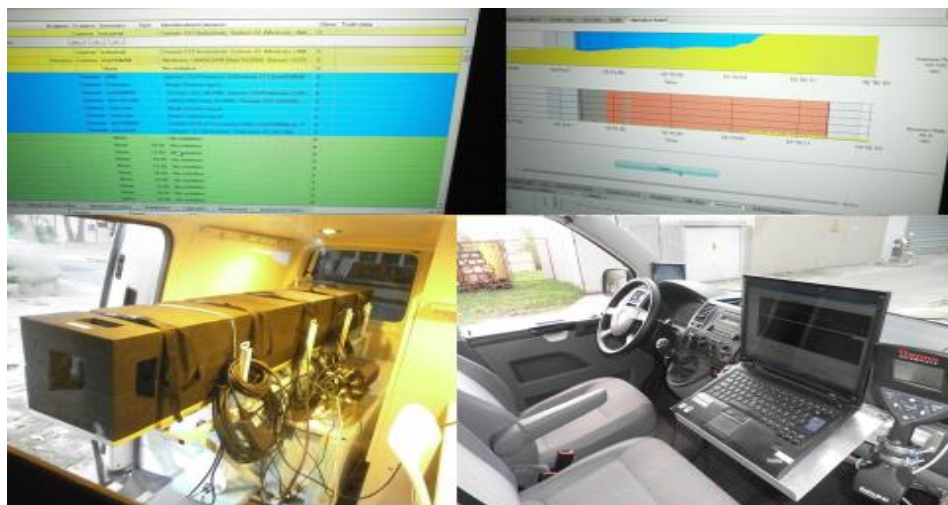
32. ábra: A mozgólaboratóriumba szerelt nagyérzékenységű detektorrendszer elemei
