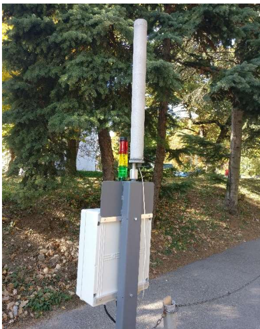
7. ábra: A gamma-szonda mérőpontok jelzése a Telephelyen
