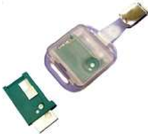
25. ábra: RADOS gamma-doziméter tok és kártya
