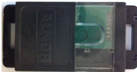
26. ábra: Albedo neutron doziméter
