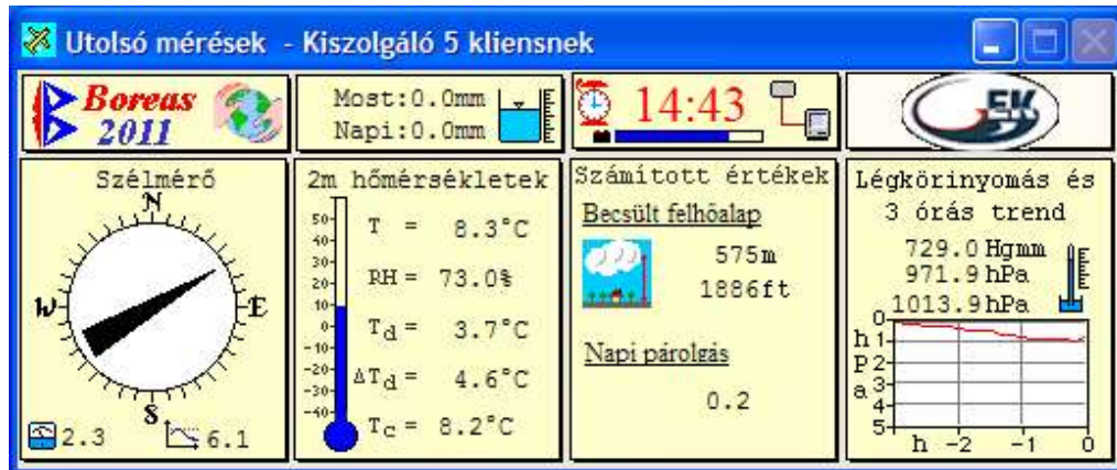
3. ábra: Boreas MeteoLux S6 mérési adatainak megjelenítése
