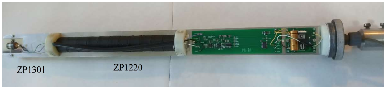
9. ábra: Gamma-szondák és belső szerelvényeik
