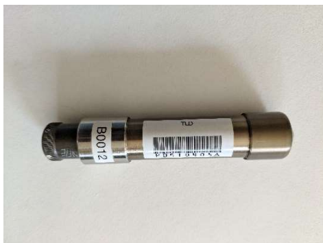
11. ábra: A Pille rendszer dózismérője
