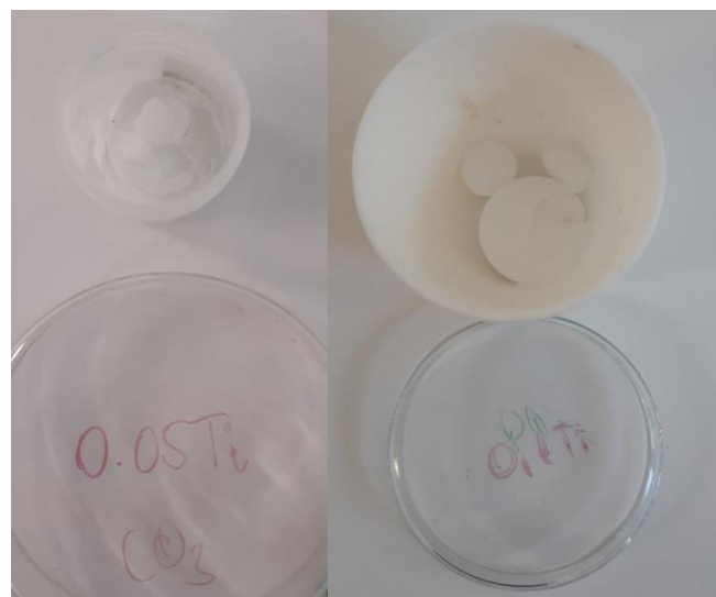
18. ábra 0,05 mólos (bal) és 0,1 mólos (jobb) titán dóolt NASICON minták szinterezés után
