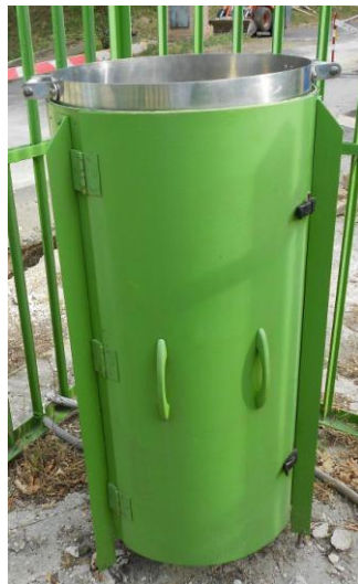
10. kép. Fall-out mérőállomás
