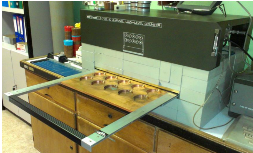
13. kép. 10 mérőhelyes gázáramlásos proporcionális számláló, az összbeta aktivitás mérésére
