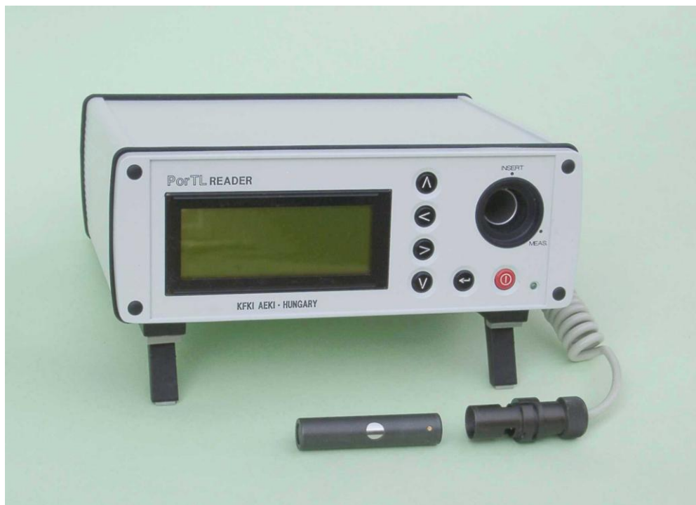
2. kép. A PorTL doziméter és a kiértékelő berendezés
