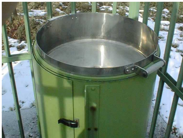
11. fénykép. Fall-out mintavétel az 1. állomáson
