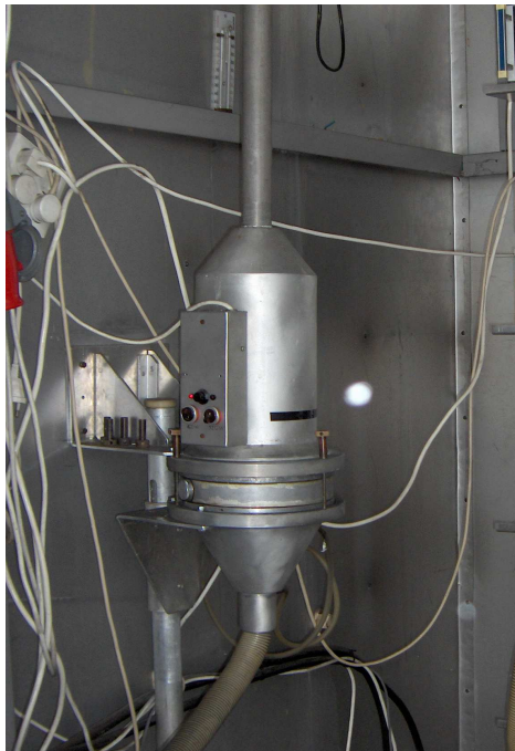
8/a. fénykép. Nagytérfogatú mintavevő az 1. állomáson
