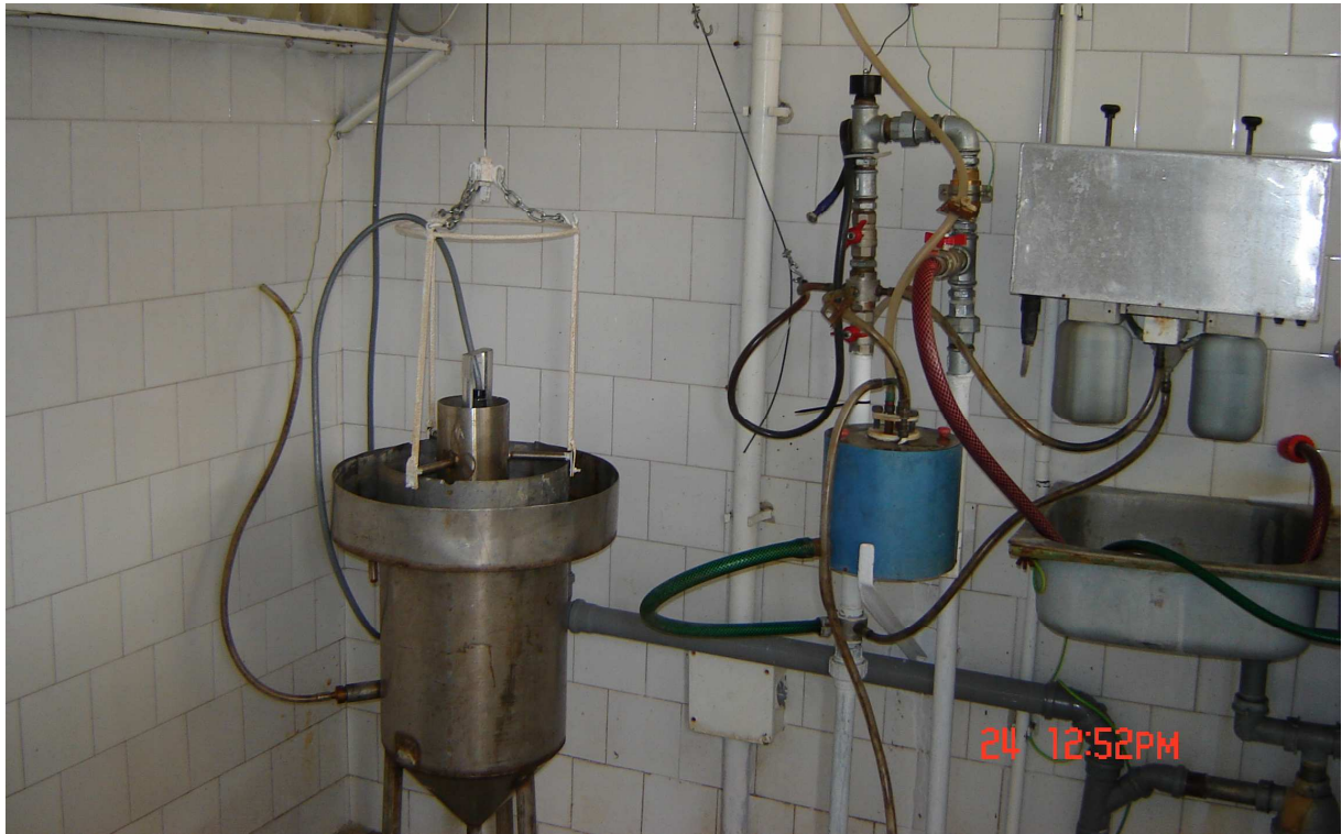
12. fénykép. Folyamatos és szakaszos mintavevő berendezés a szennyvíz-mintavevő állomáson
