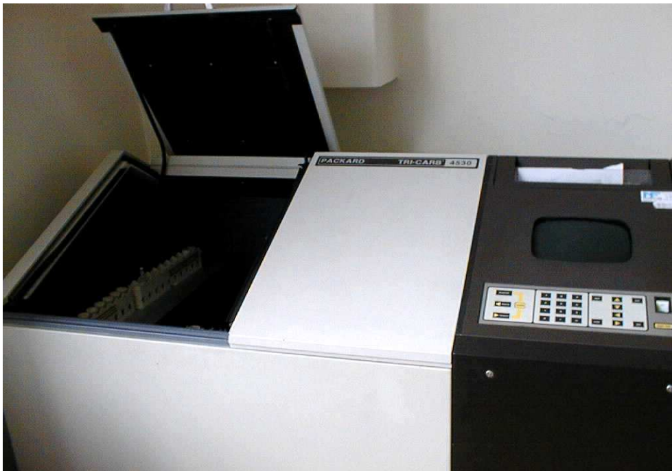
14. fénykép. TRICARB készülék a kisenergiájú béta-sugárzás mérésére
