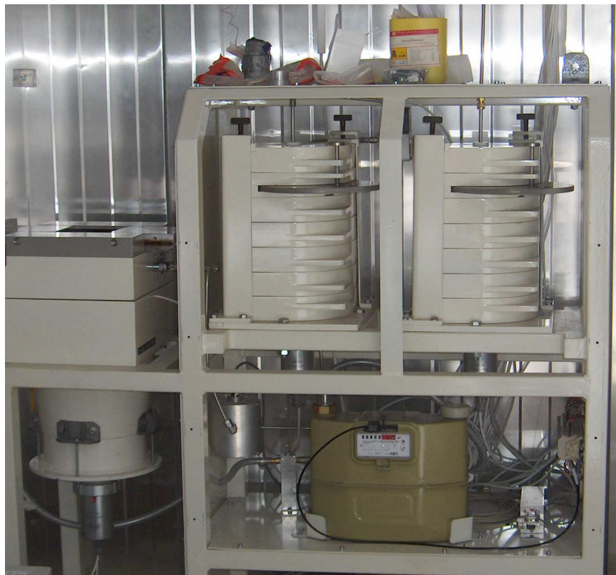
10. fénykép: Folyamatos levegő mintavevő a referencia állomáson
