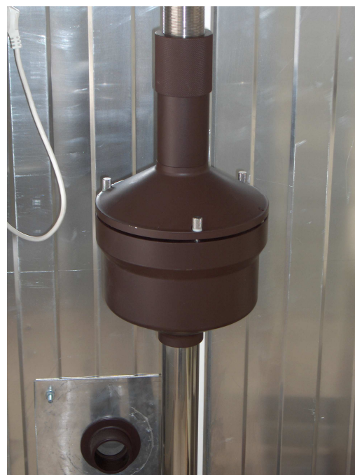
8/b fénykép. Nagytérfogatú mintavevő a referencia állomáson
