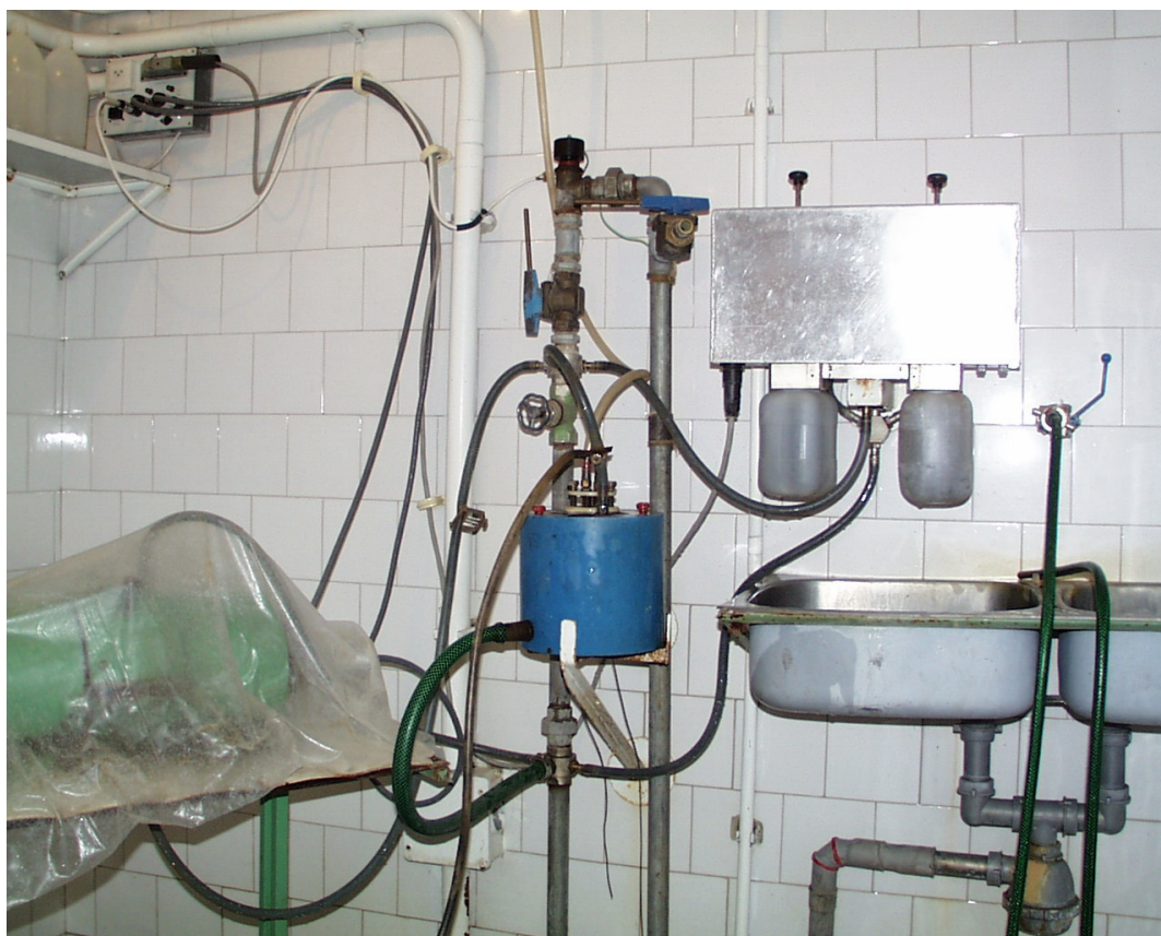
12. fénykép. Folyamatos és szakaszos mintavevő berendezés a szennyvíz-mintavevő állomáson
