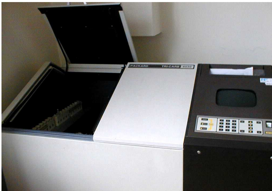
14. fénykép. TRICARB készülék a kisenergiájú béta-sugárzás mérésére
