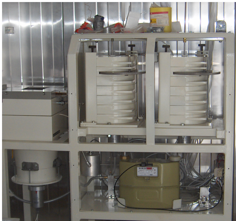
10. fénykép: Folyamatos levegő mintavevő a referencia állomáson
