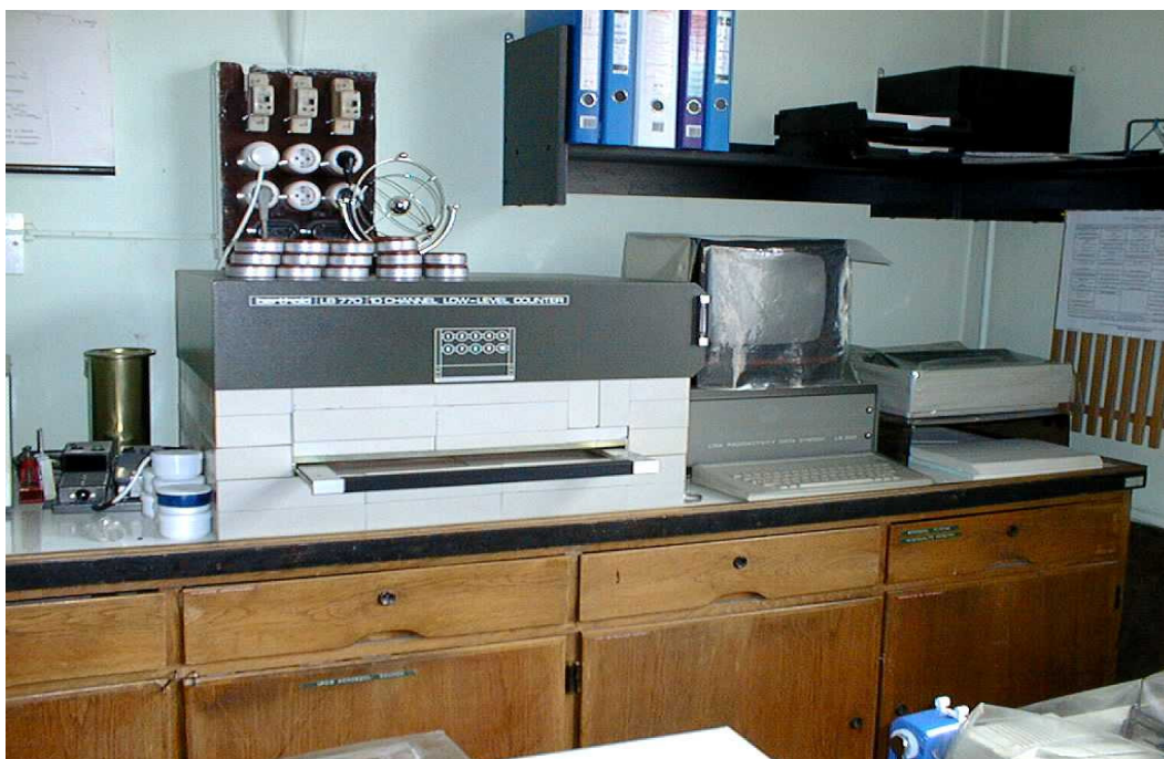
13. fénykép. A 10 mérőhelyes gázáramlásos proporciónális számláló az összbeta aktivitás mérésére
