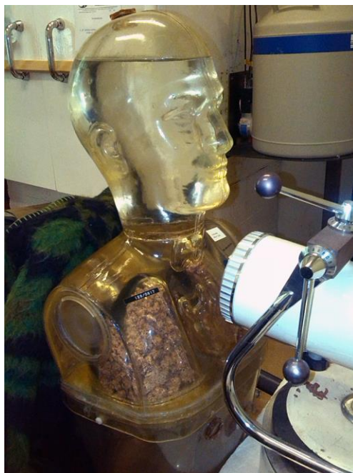
3.kép Pajzsmirigy mérése fantomon, a Mozgólaboratóriumhoz tartozó pajzsmirigymérő berendezéssel
