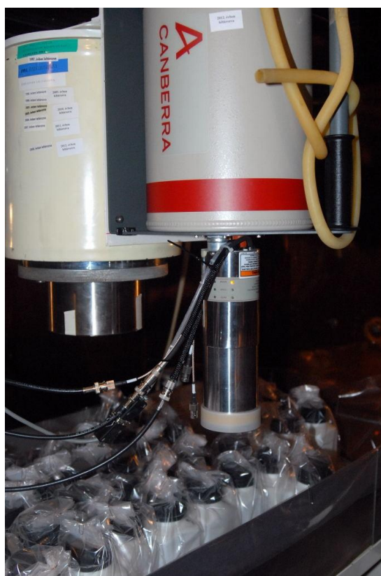
5. kép Az egésztest számláló berendezés kalibrálás közben
