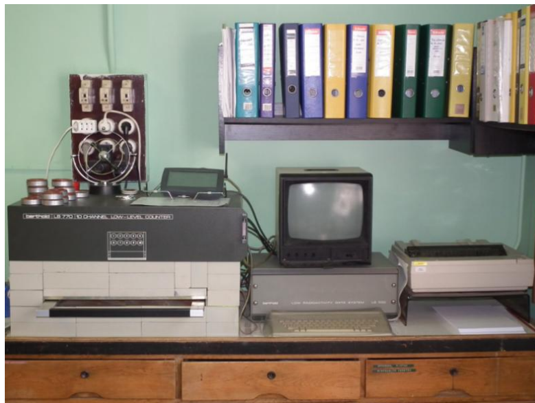
10 mérőhelyes gázáramlásos proporcionális számláló összbéta aktivitás mérésére
