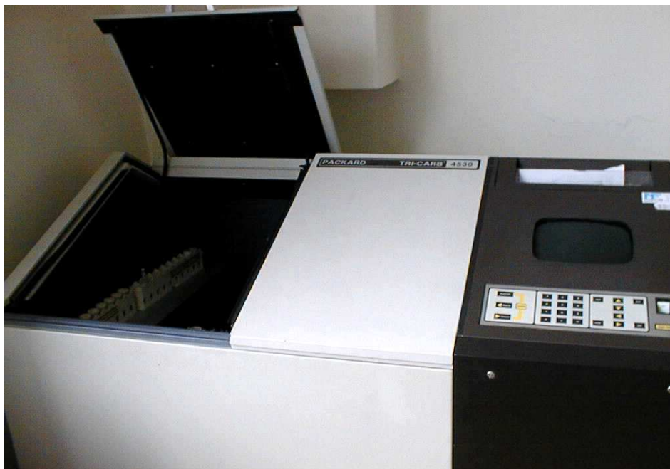
16. kép. TRICARB készülék a kisenergiájú béta-sugárzás mérésére
