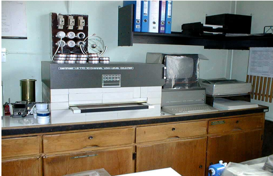
15. kép. A 10 mérőhelyes gázáramlásos proporcionális számláló az összbeta aktivitás mérésére
